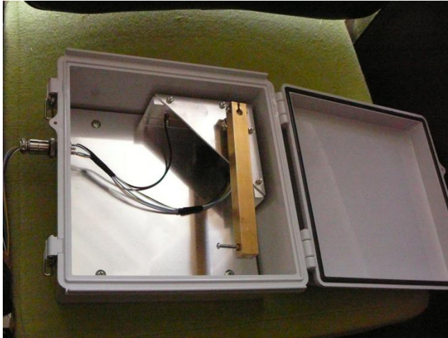
図4 ELエンコーダの軸が錘の荷重のために中心からずれてしまう
